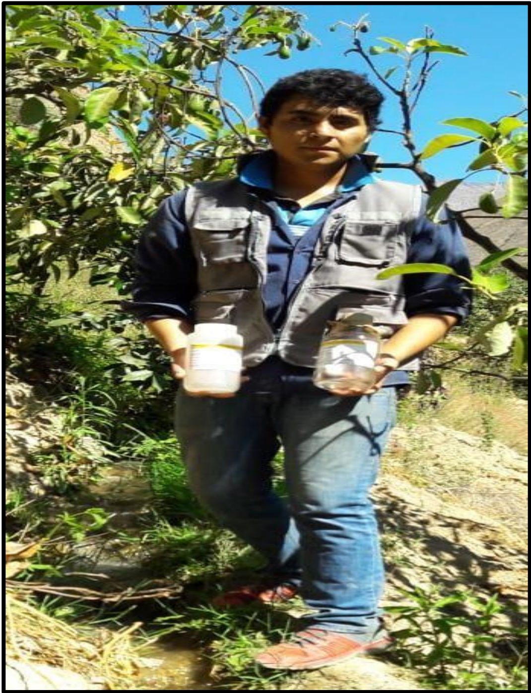
Figura 32: Fotografía de la toma de muestra de agua para su análisis físico, químico y bacteriológico.
