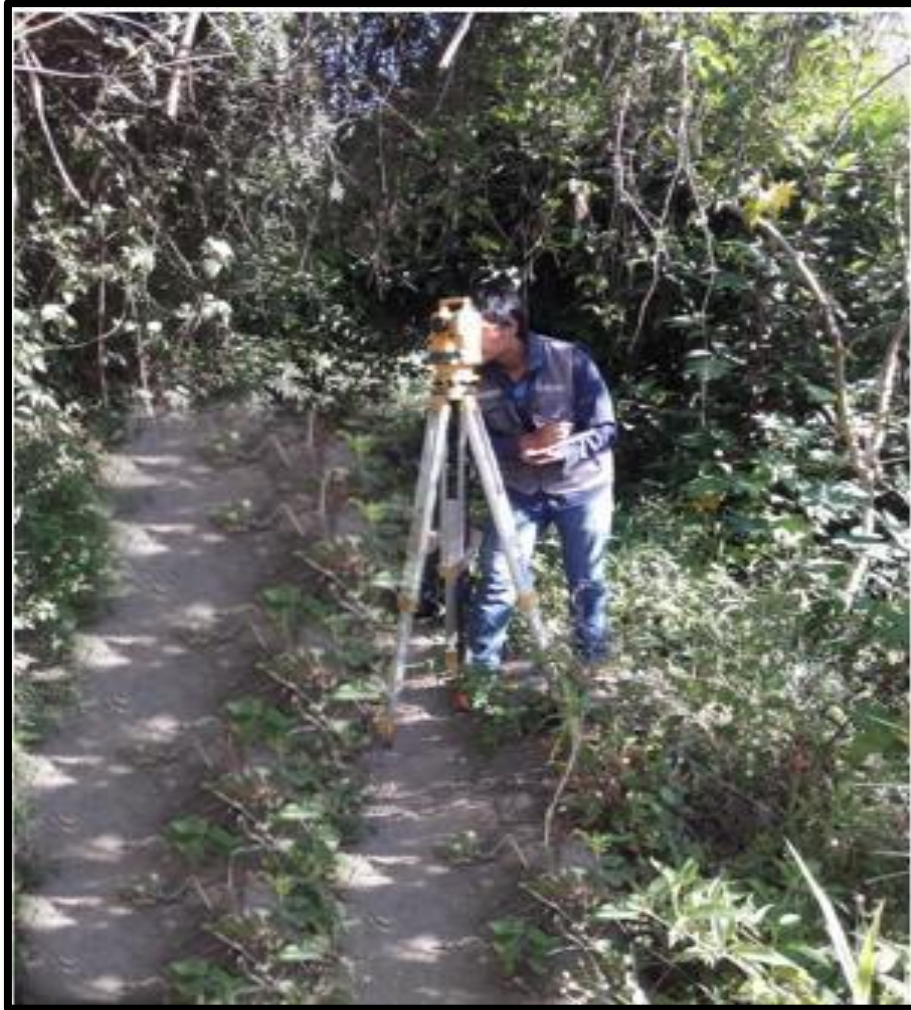
Figura 37 y 38: Fotografía Realizando el levantamiento topográfico donde se proyectó la línea de conducción
