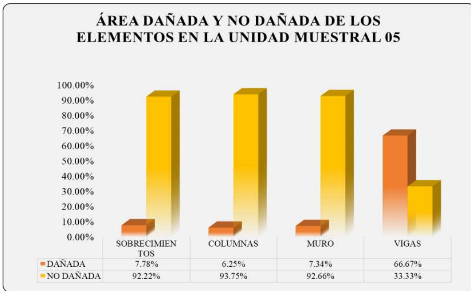
Gráfico 20: Porcentaje de Área Dañada y No Dañada de los Elementos de la Unidad Muestral 05.
