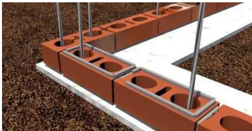
Figura 12: Muro de Albañilería Armada.
