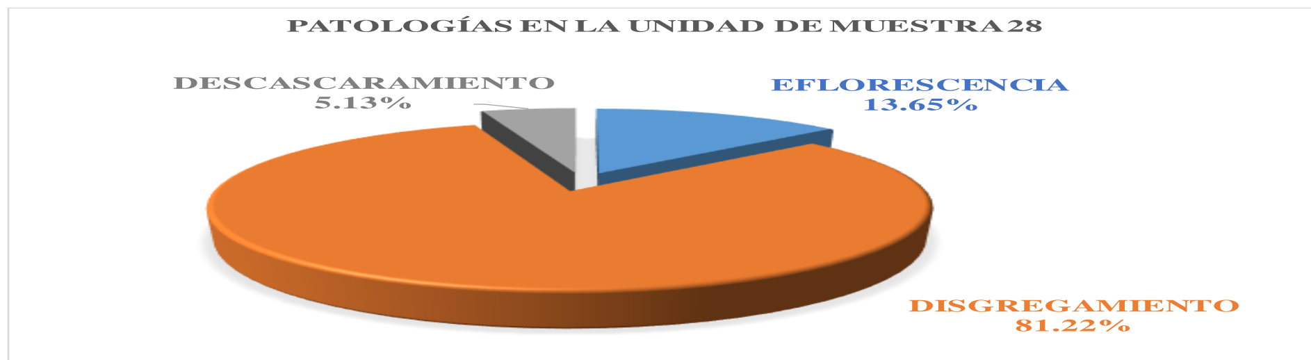
Figura 158. Gráfico de las patologías encontradas en la unidad de muestra 28.
