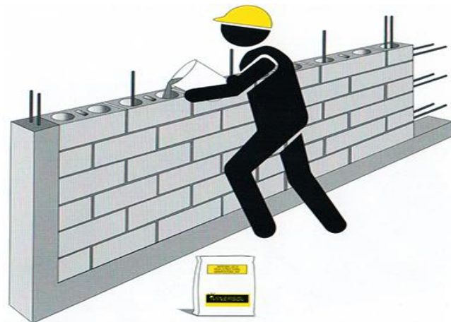
Figura 14. Llenado del grout en el muro armado.
