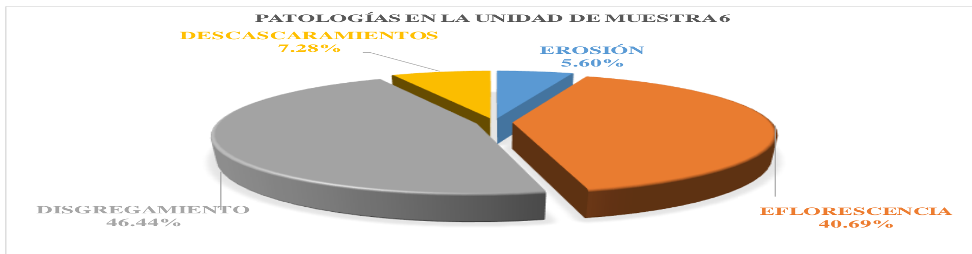
Figura 70. Gráfico de las patologías encontradas en la unidad de muestra 6.
