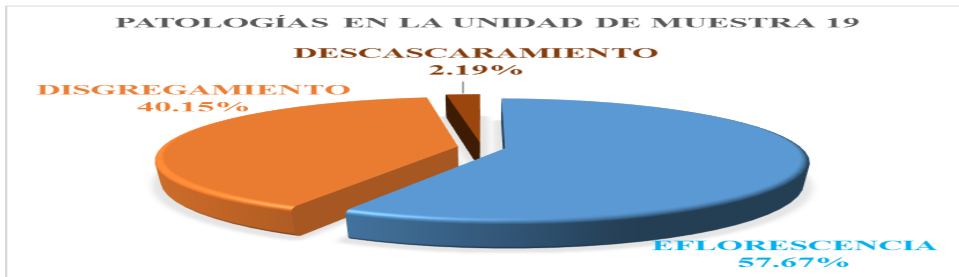
Figura 122. Gráfico de las patologías encontradas en la unidad de muestra 19.
