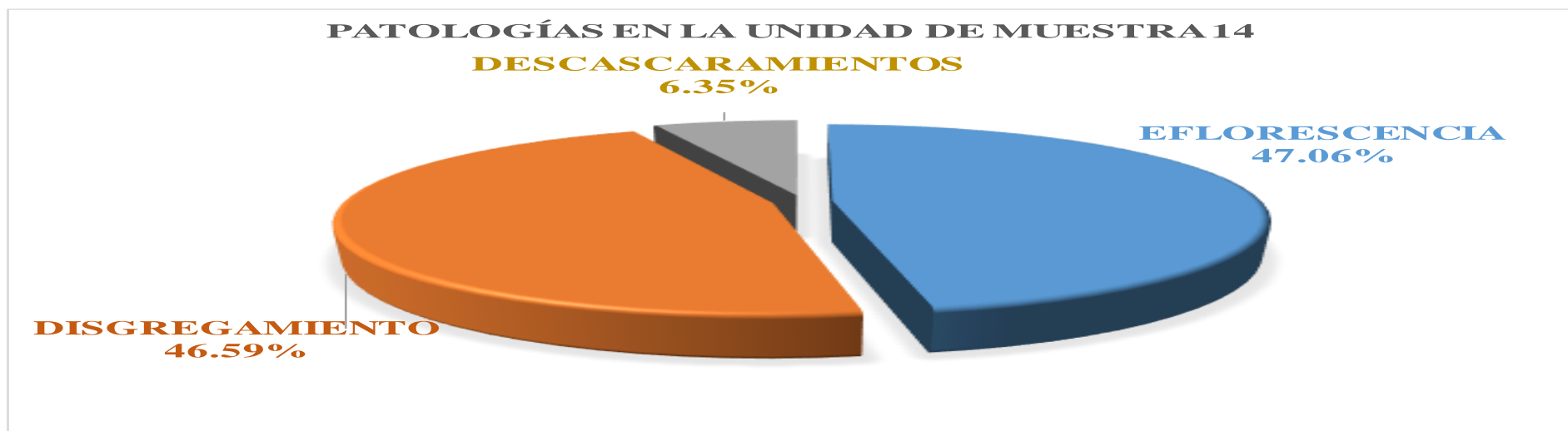
Figura 102. Gráfico de las patologías encontradas en la unidad de muestra 14.
