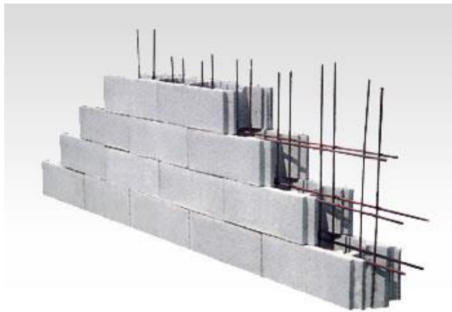
Figura 13. Muro armado con refuerzos vertical y horizontal.
