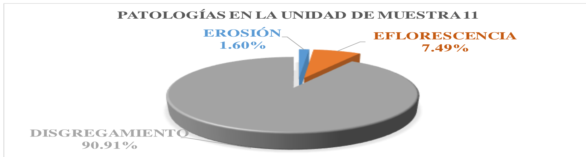
Figura 90. Gráfico de las patologías encontradas en la unidad de muestra 11.
