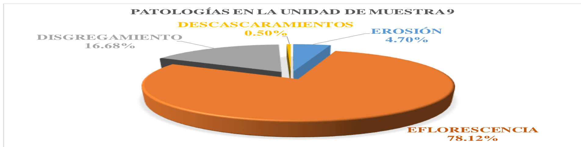
Figura 82. Gráfico de las patologías encontradas en la unidad de muestra 9.
