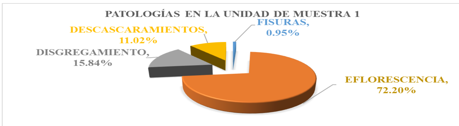
Figura 50. Gráfico de las patologías encontradas en la unidad de muestra 1.
