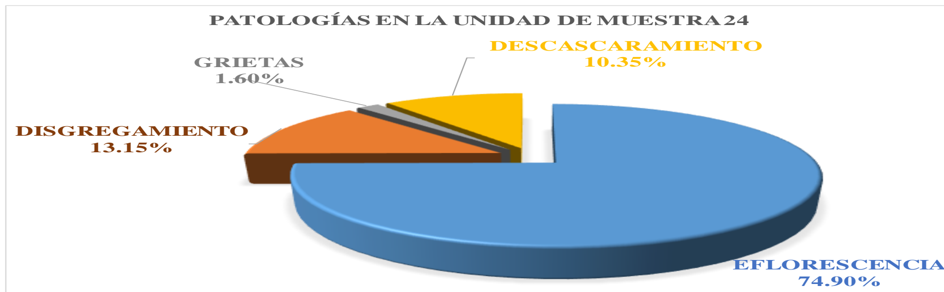
Figura 142. Gráfico de las patologías encontradas en la unidad de muestra 24.
