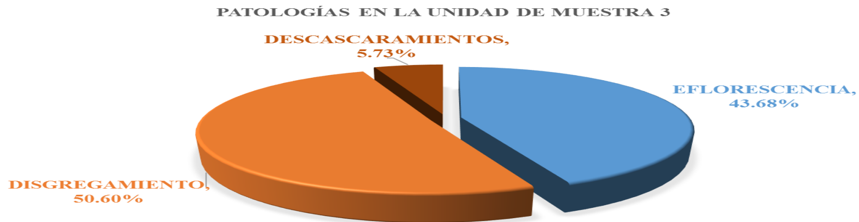
Figura 58. Gráfico de las patologías encontradas en la unidad de muestra 3.
