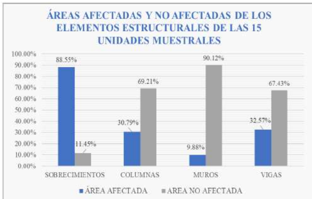
Gráfico 2: Porcentaje de Áreas Afectadas de los Elementos Estructurales.
