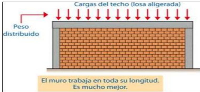
Imagen 04: Albañilería confinada. Fuente: Aceros Arequipa. (2016)
