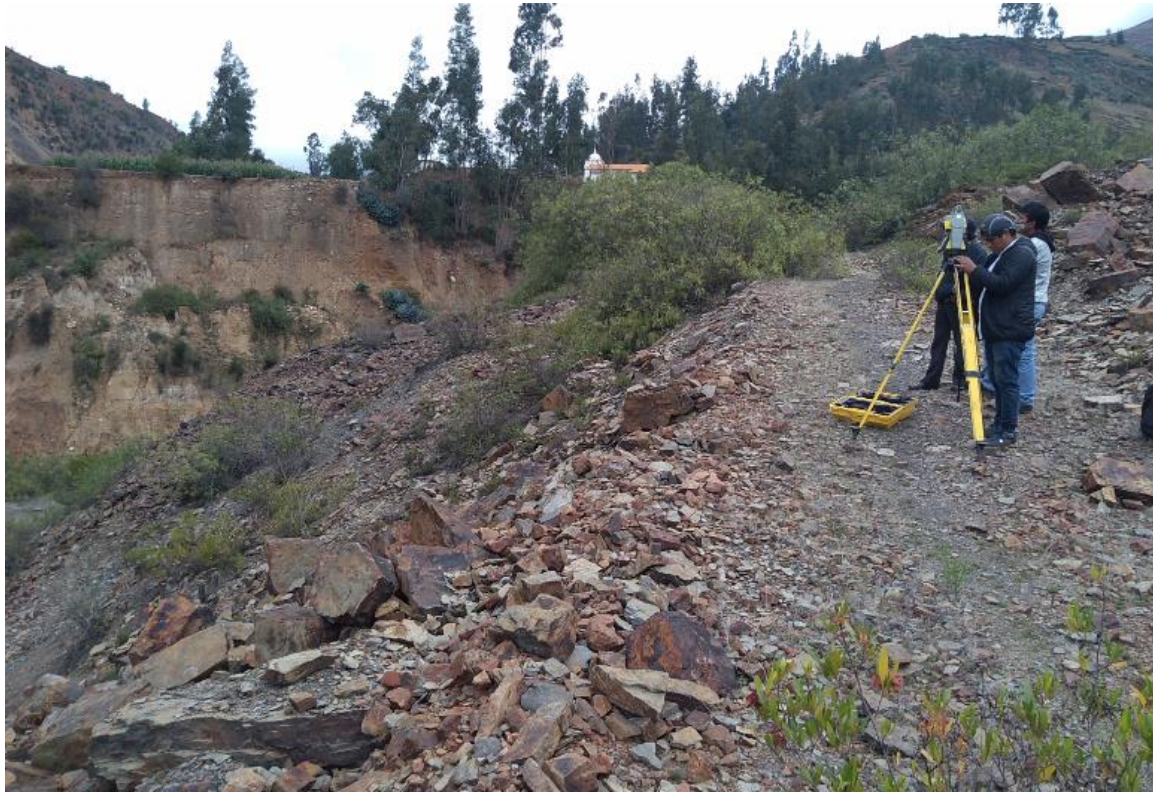
Foto 05. Realizando el levantamiento topográfico para el diseño del alcantarillado sanitario.
