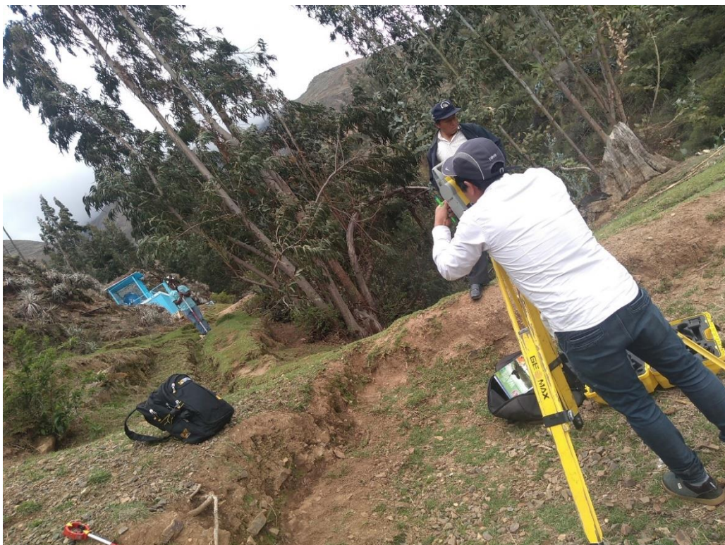
Fotografia 4. Realizando el levantamiento topografico
