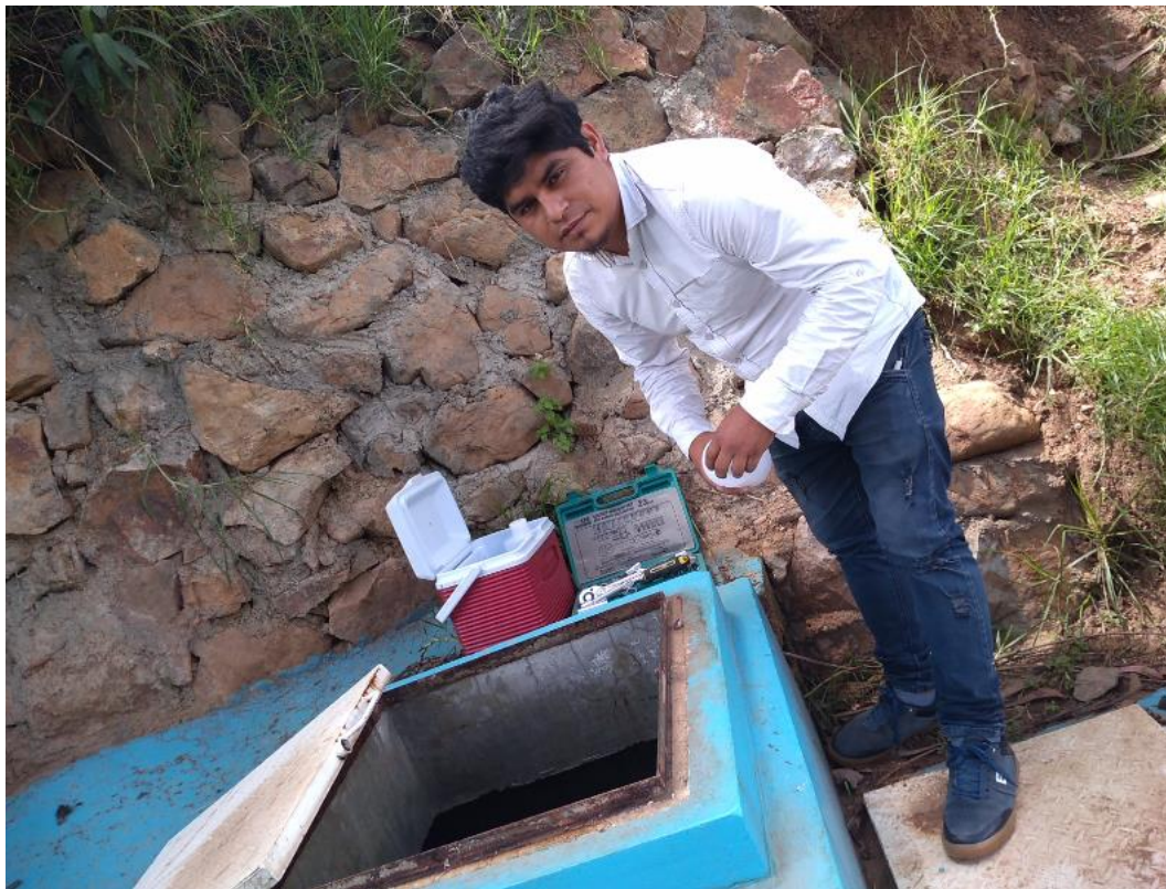
Foto 04. Recojo de agua en la captación para el análisis de laboratorio (Físico, Químico y Microbiológico)
