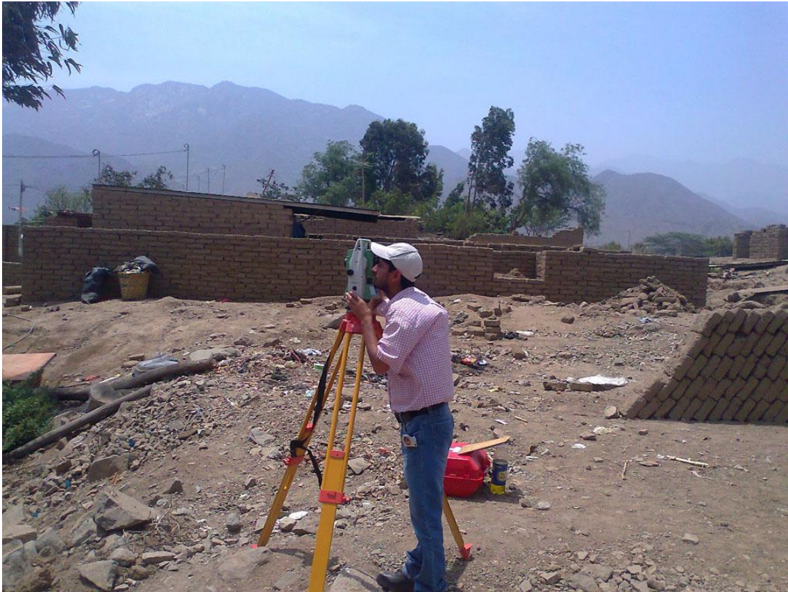
Foto 01. En proceso de levantamiento topográfico del centro poblado Muña Alta
