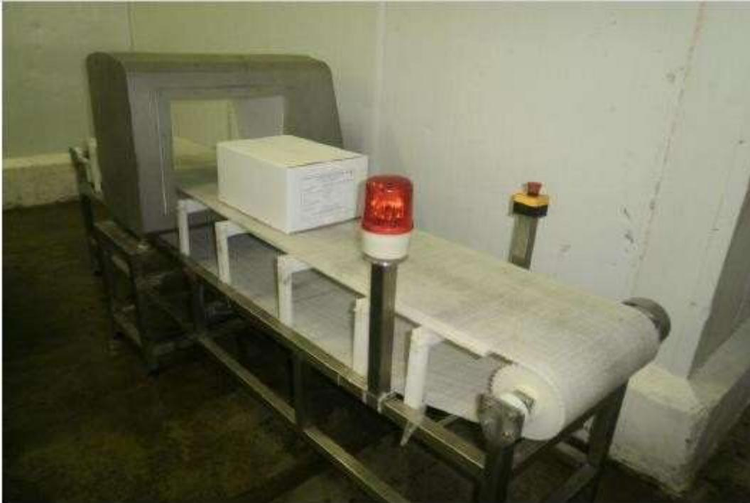
Fig 13 Control de detección de metales pesados
