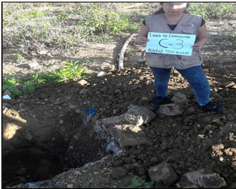
FOTO 03: SE OBSERVA LA EXCAVACIÓN CALICATA C-03.
