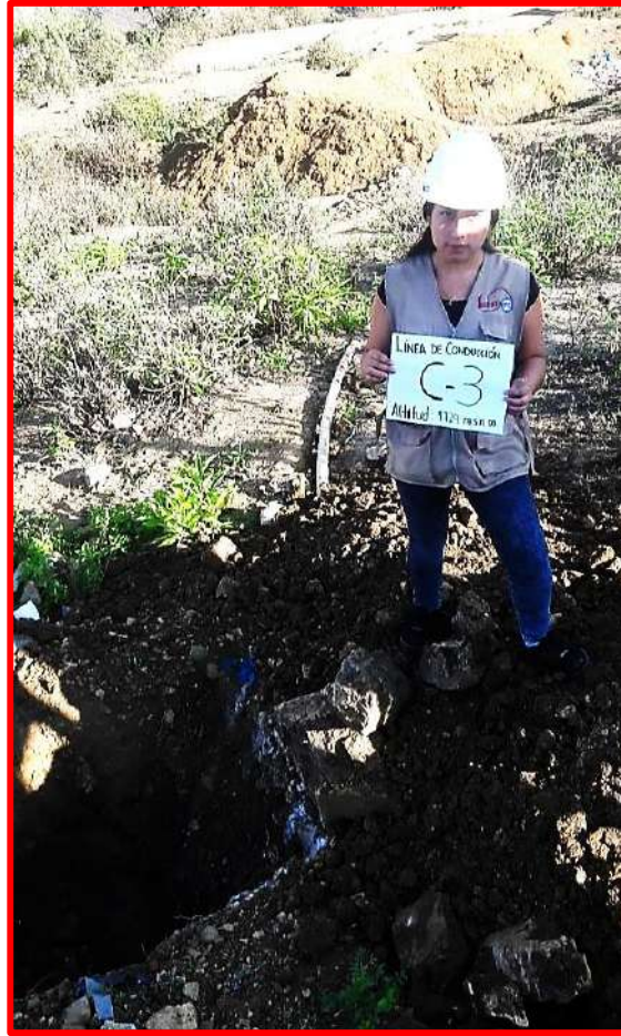
Imagen 12. Calicata N° 03 en la Línea de Conducción.
