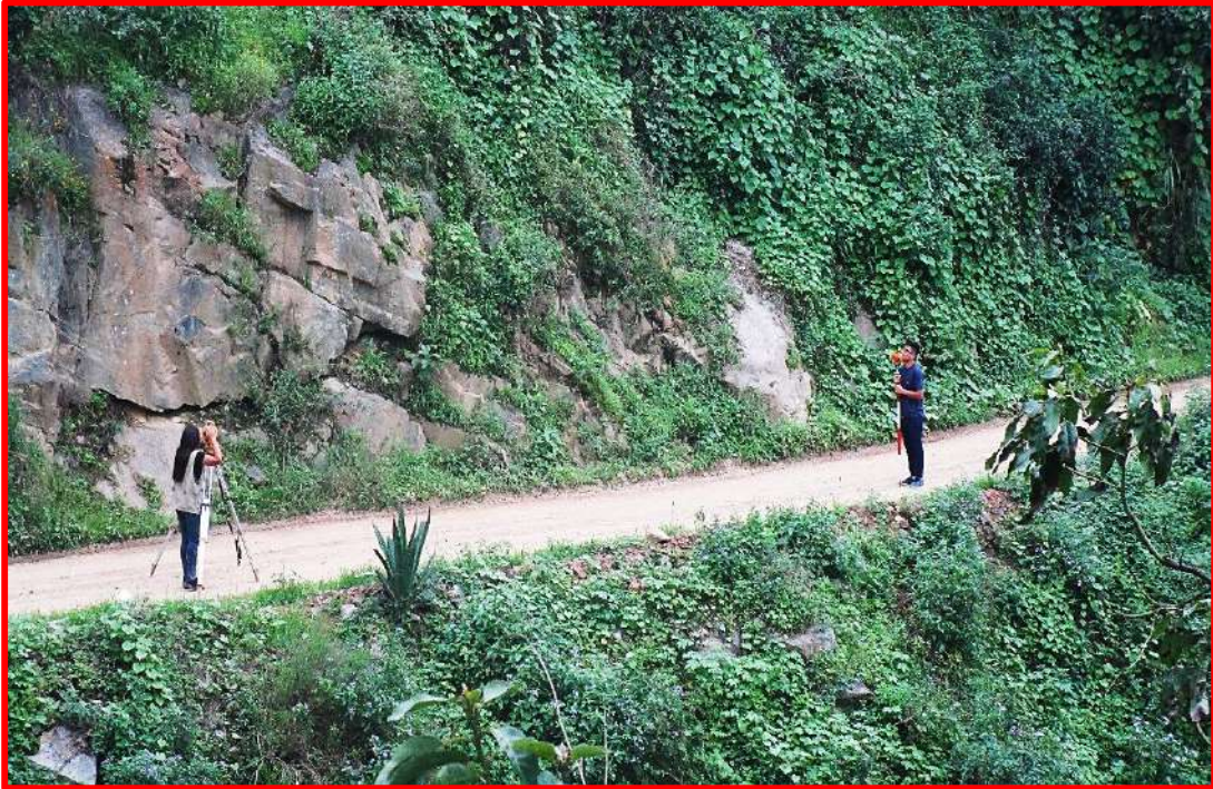
Imagen 10. Levantamiento topográfico de la Línea de Conducción.
