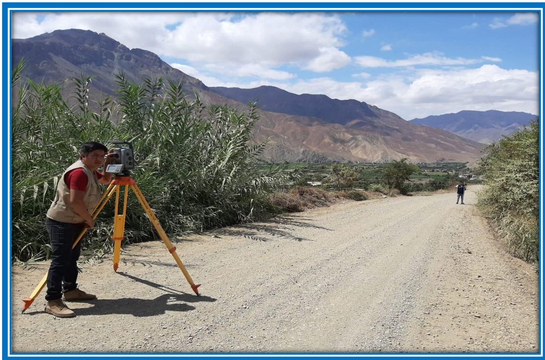
Foto N° 10.- Se observa que se está realizando el levantamiento topográfico con el equipo de estación total.
