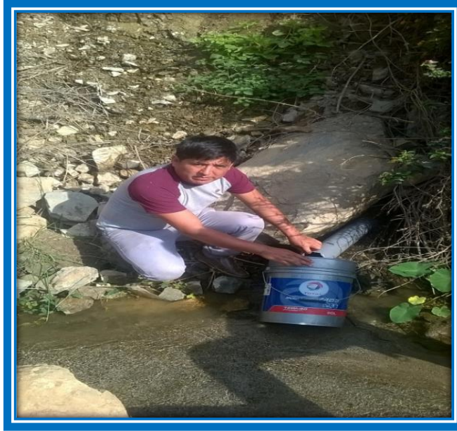
Foto N° 05.- Se hizo la medición de la fuente de caudal utilizando balde de 20 lt y tubería de 2 pug. Se controló el tiempo de llenado con cronometro así obtuvimos 2.74 l/seg
