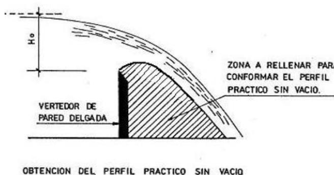
Imagen 2: Vertedor de pared delgada. Fuente: Estrada G.
