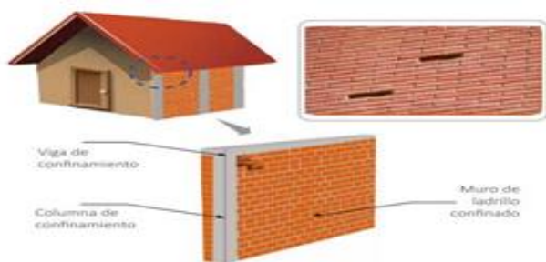
Gráfico 8 : Imagen de desprendimiento de ladrillo
