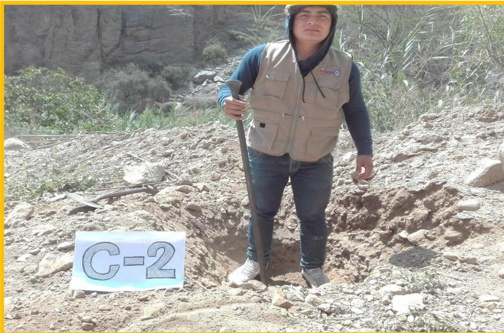
**Imagen N° 09:** Se puede apreciar excavando la calicata 2 en la línea de conducción para su respectivo estudio de mecánica de suelos.
