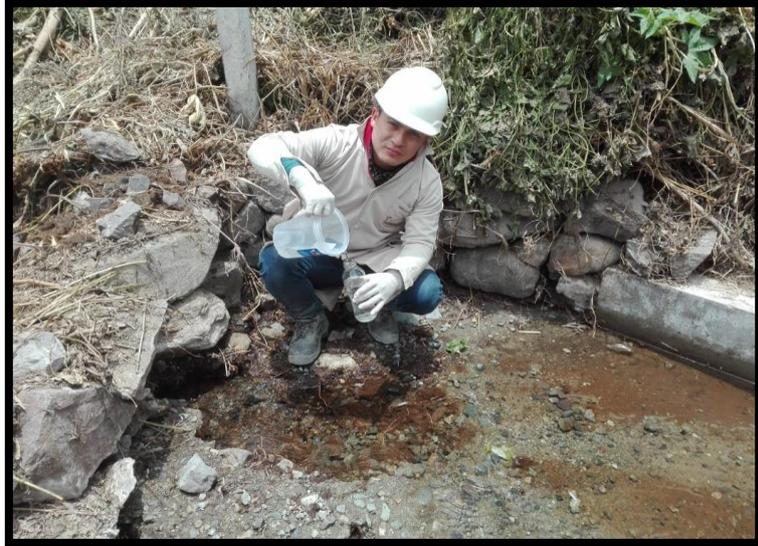
**Figura 16:** Extracción de muestra para determinar en laboratorio la calidad del agua.
