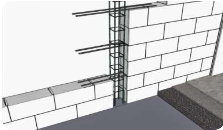
**Figura 10.** Muro Portante o de Carga.
