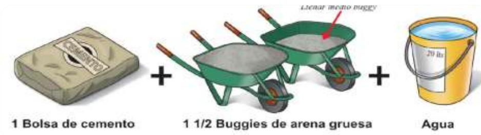
**Figura 15.** Dosificación de mortero para asentado de ladrillo y tarrajeo.
