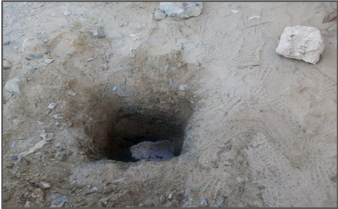
Fotografía 15: En la calicata se encontró el nivel freático a 65 centímetros de profundidad.
