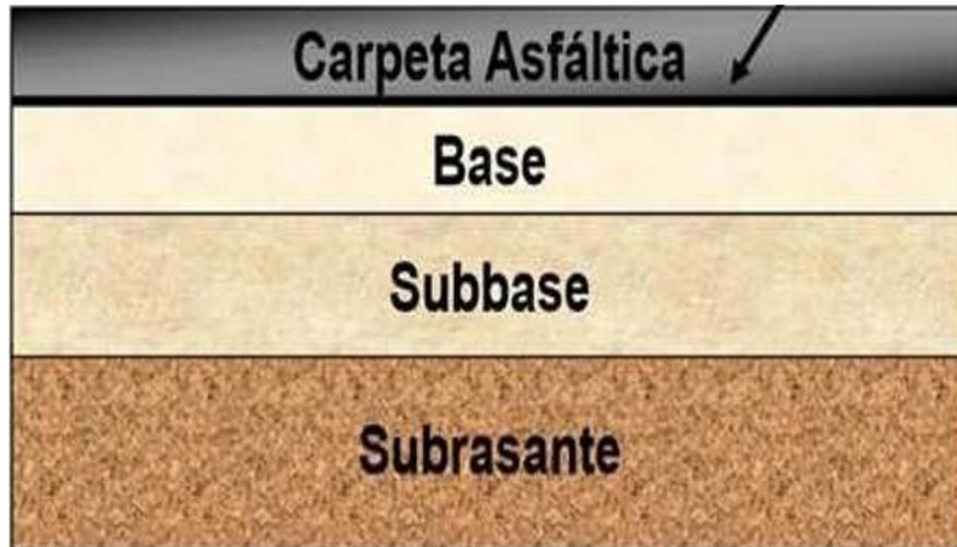
Figura 2.1: Estructura del pavimento flexible.
