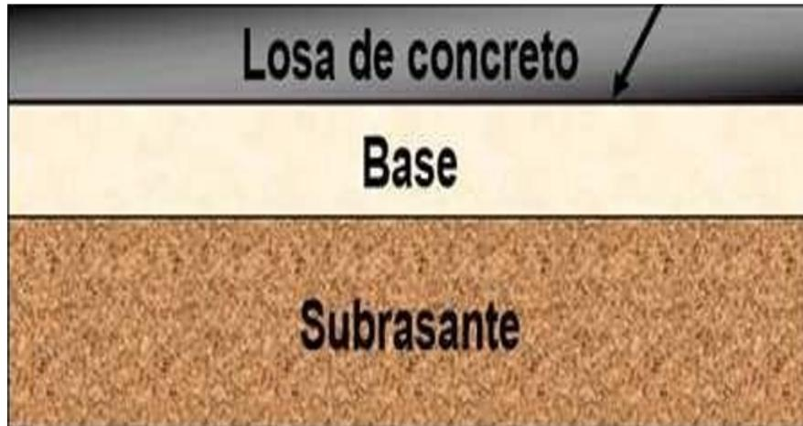
Figura 2.2: Estructura del pavimento Rígido.
