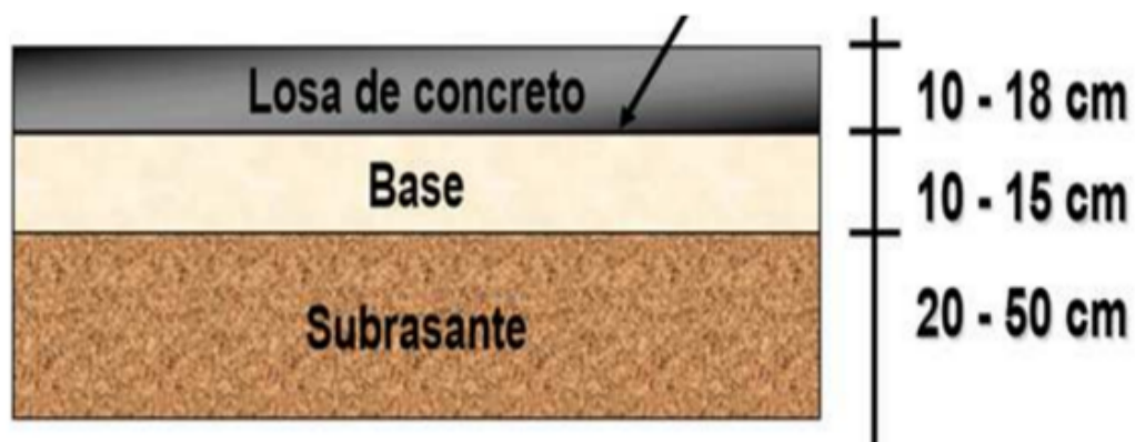
Figura 2.1: Sección transversal del pavimento rígido. Fuente: (Claudio Giordani,2018).
