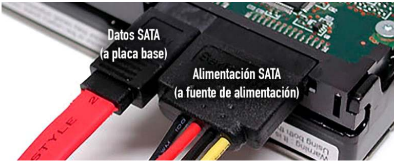
Figura 163. Conexión del disco duro SATA.
