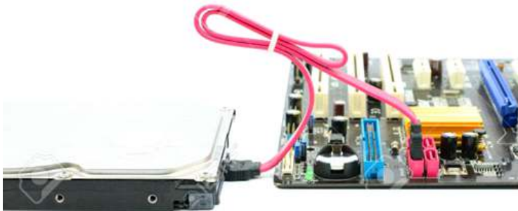
Figura 160. Conexión del disco duro con SATA a la placa madre.
