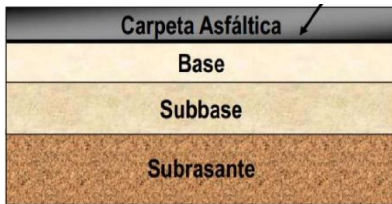
Figura 2.1: Estructura de un pavimento flexible.
