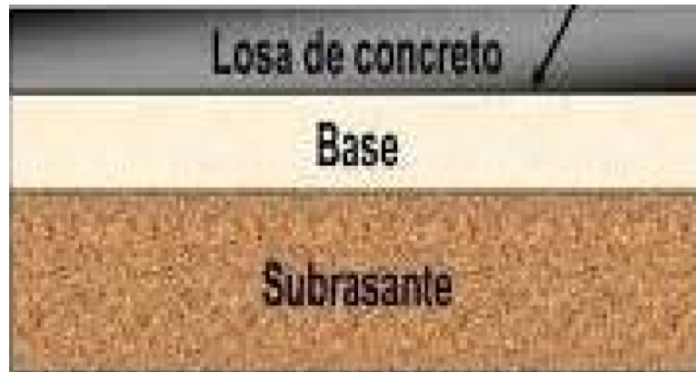
Figura 2.2: Estructura del pavimento rígido. Fuente: (Edgar Rodríguez, (2009)).
