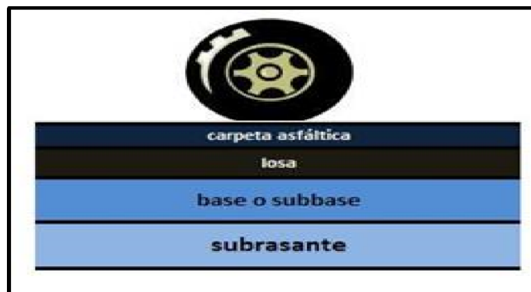
Figura 2.3: Estructura del pavimento rígido. Fuente: (Edgar Rodríguez, (2009)).
