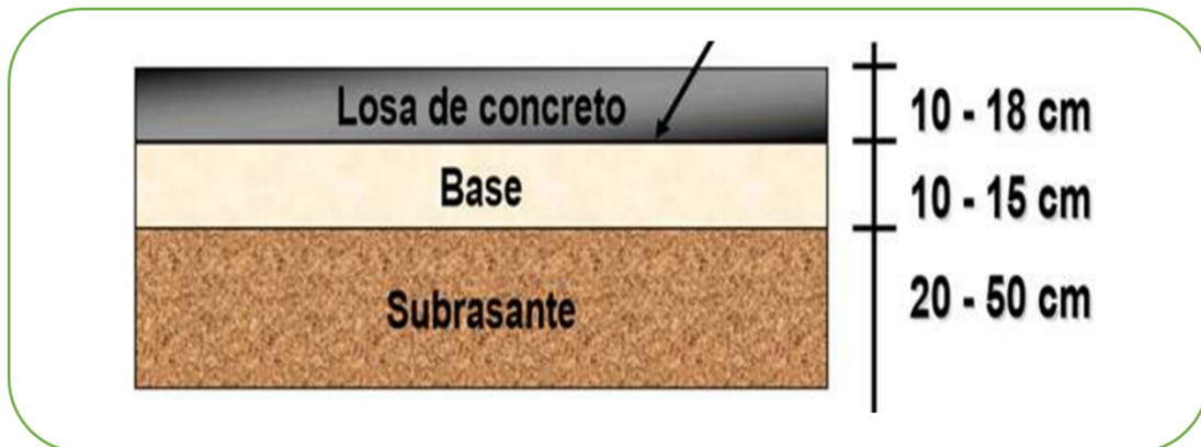
Figura 2.1: Sección transversal del pavimento rígido.
