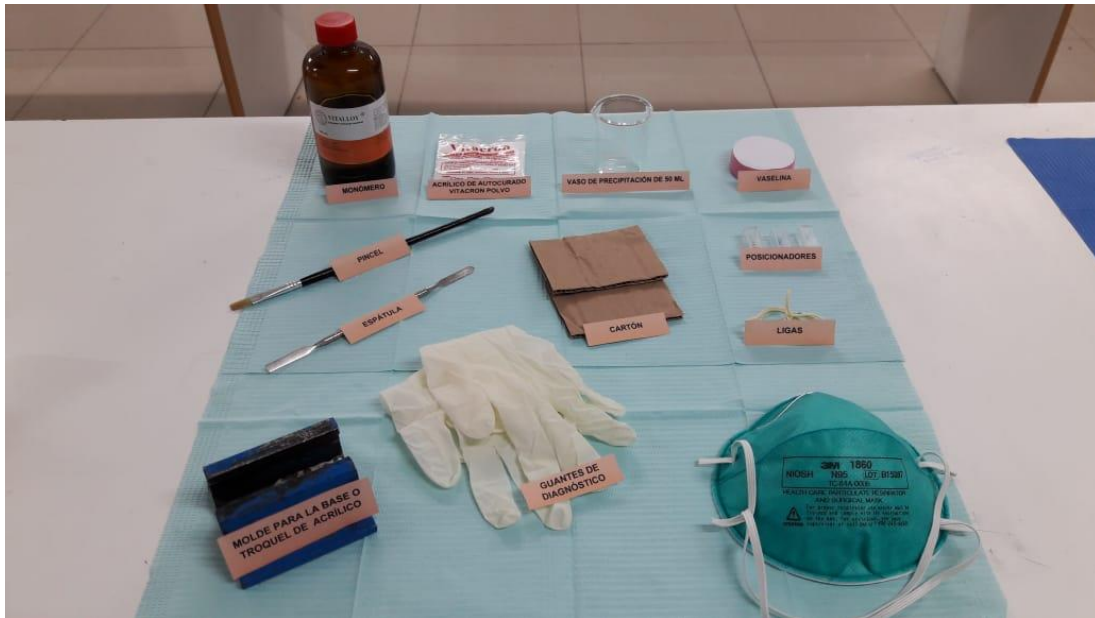
IMAGEN 22: materiales para la elaboración de la base del ensayo y sujeción de las piezas dentales sobre la mesa.
