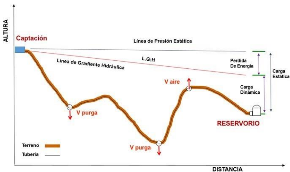
Ilustración N° 03.31. Línea de Conducción
