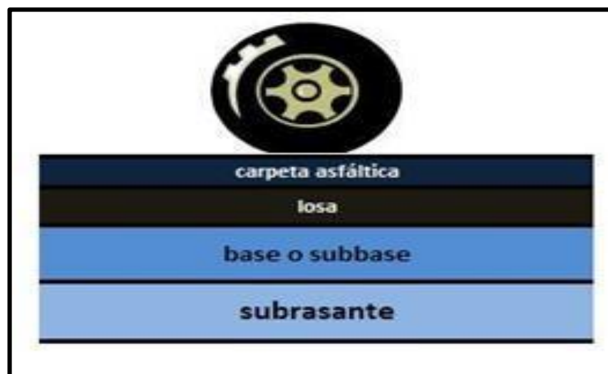
Imagen N° 3: Estructura de un pavimento mixto Fuente: Rodríguez, E.- Cálculo del índice de condición del pavimento flexible en la av. Luis Montero, distrito de Castilla. (2009).
