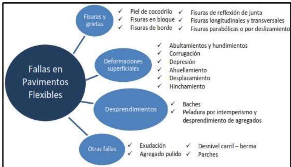
Imagen N° 4: Fallas en pavimentos flexibles
