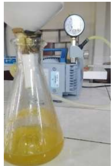
Figura 9. Obtención del extracto hidroetanólico del ajo
