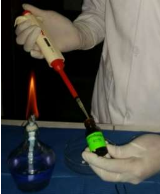
Figura 19. .Agregando en los papeles filtros las concentraciones de extracto hidroetanólicos al 40, 70 y 100 %
