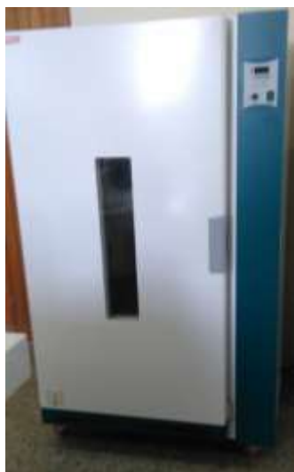
Figura 10. Secado del ajo en la estufa con circulación de aire forzado a 40°C.
