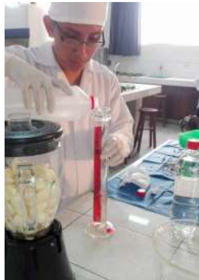
Figura 5. Agregación de 500 ml de alcohol al 96 % y 125 de agua destilada
