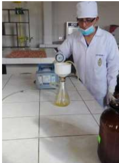
Figura 8. Colocación de del macerado de ajo en el motor de precipitación al vacío
