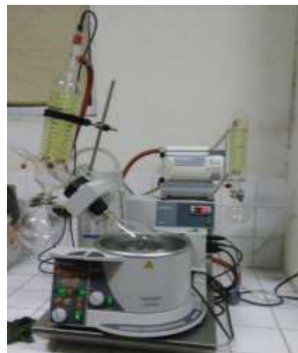
Figura 11. Eliminando el solvente del extracto hidroetanólico de ajo en el equipo de rotavapor.
