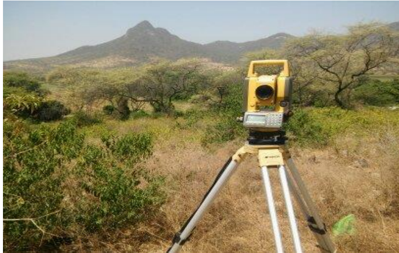
Gráfico 6 Modelo del equipo empleado en el levantamiento topográfico Estación Total
