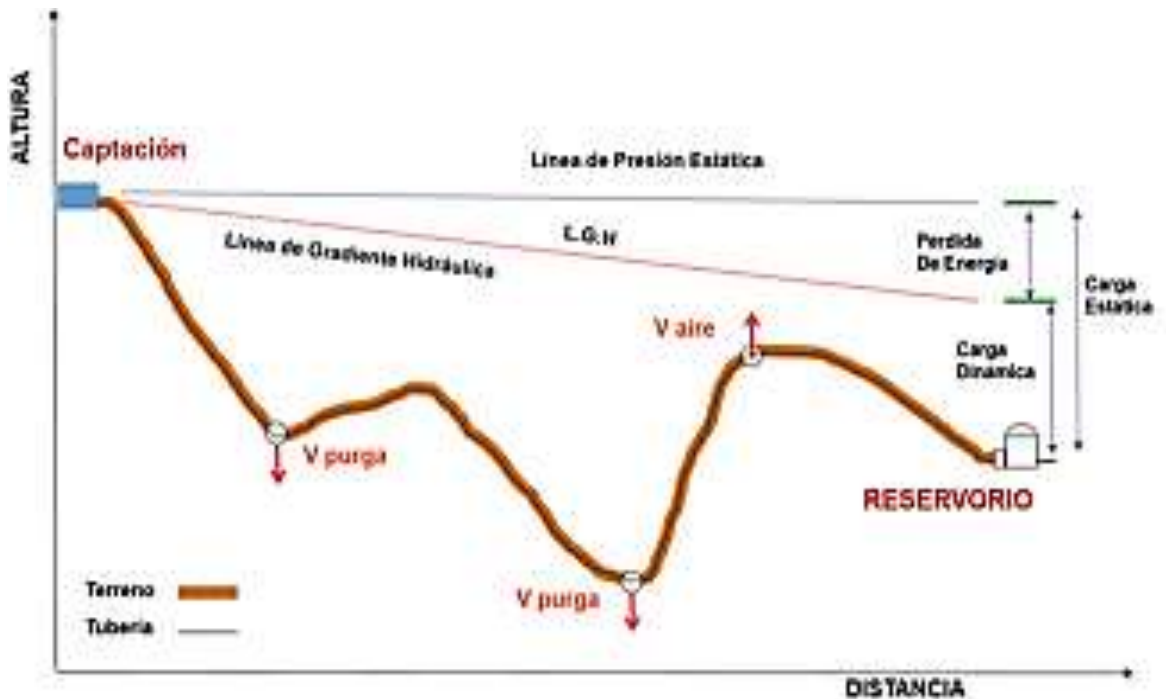
Figura N° 4: Línea de conducción.
