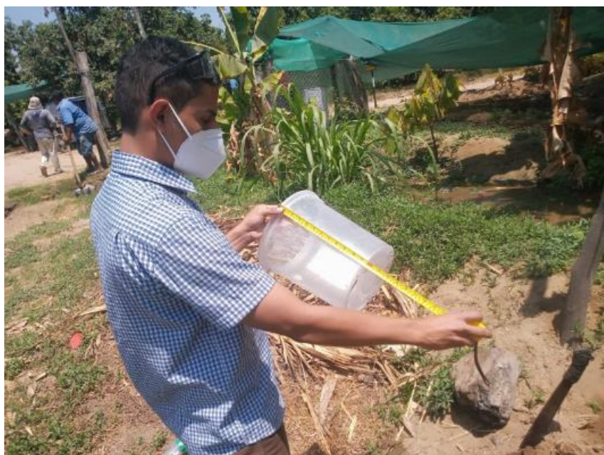
Gráfico 39: Caudal aforado del pozo de laderas
