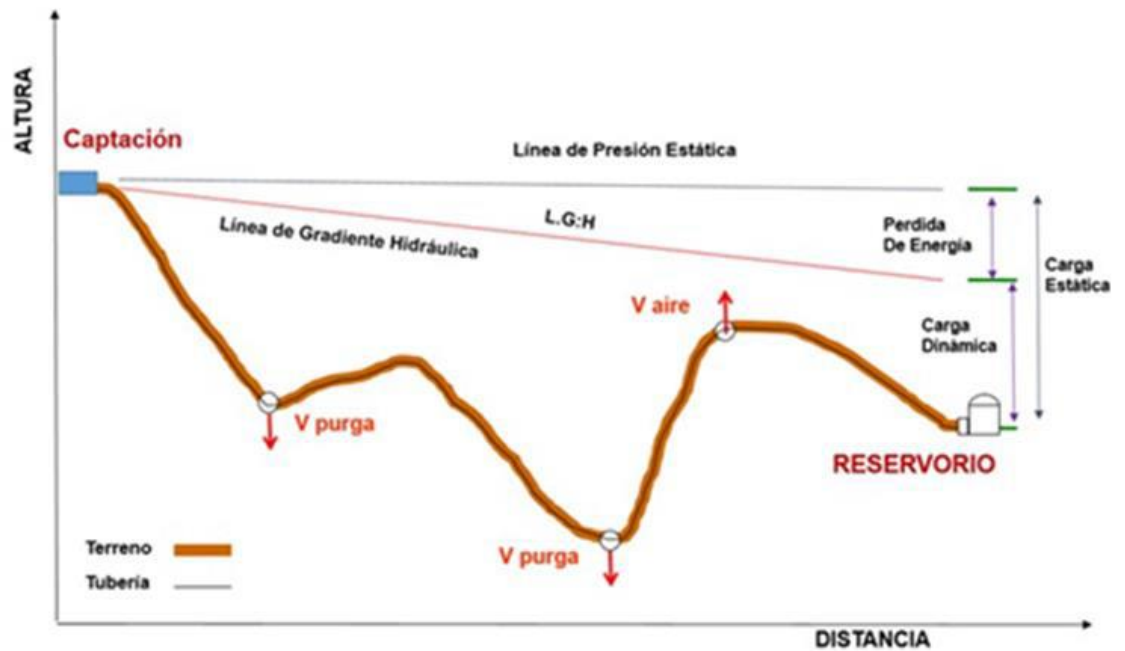
Figura 2: Esquema típico de Línea de Conducción
