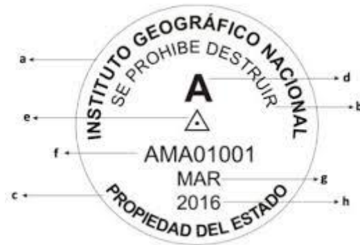
Figura 9: Modelo de placa de Bronce para punto de control Geodésico
