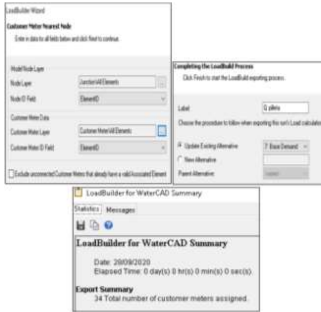
Imagen 26: Ingreso de caudales de agua en 34 piletas
