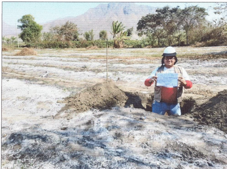
Foto N° 02.- Se aprecia la vista panorámica de calicata C-02 de la LÍNEA DE CONDUCCIÓN (Tramo 01)
