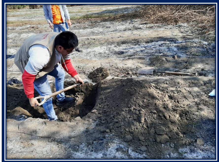
Imagen 9. Relizando las calicatas para el estudio de suelo del caserío de Breña Isco.
