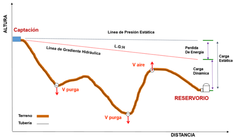
Imagen N° 2. Línea De Conducción.
