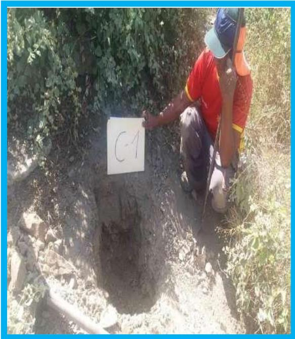
FOTOGRAFÍA N°11: SE PEDE APRECIAR LA REALIZACIÓN DE LAS CALICATAS PARA EL ESTUDIO DE SUELOS
