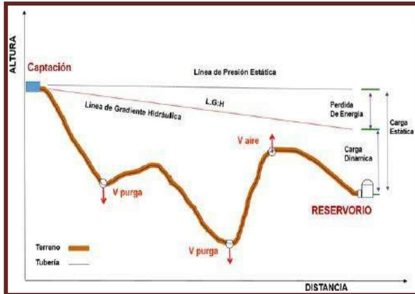
**Figura 8.** Cargas estática y dinámica de la línea de conducción
