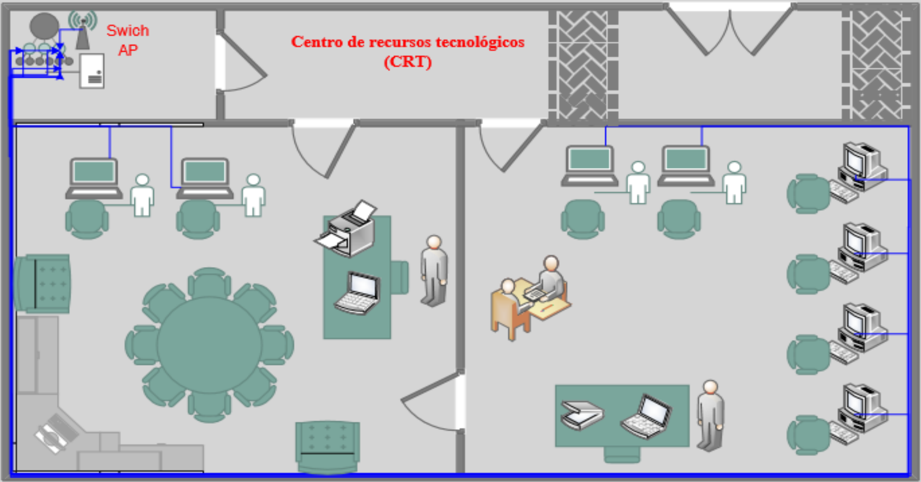
Gráfico Nro. 23: Diseño físico del recorrido de los cables en el CRT.
