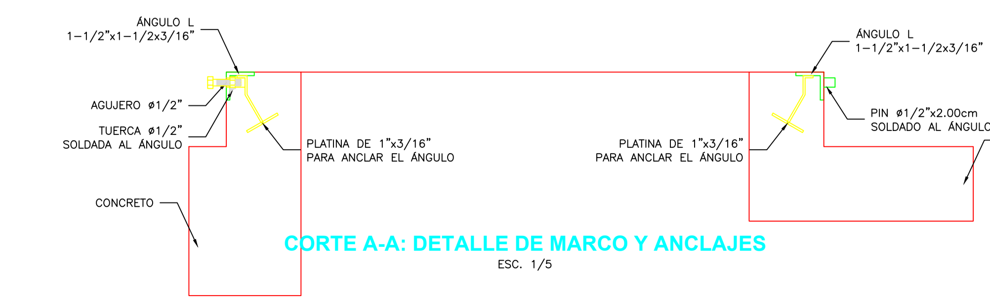
CORTE A-A: DETALLE DE TAPA METALICA ESC. 1/5
