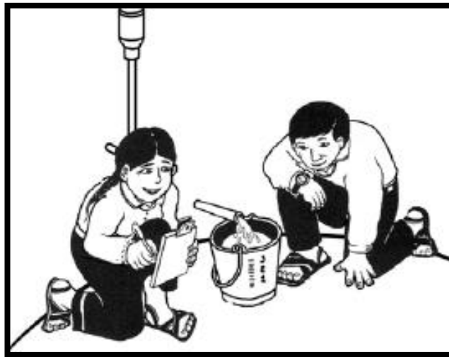
Figura 5: Medición de caudal método volumétrico
