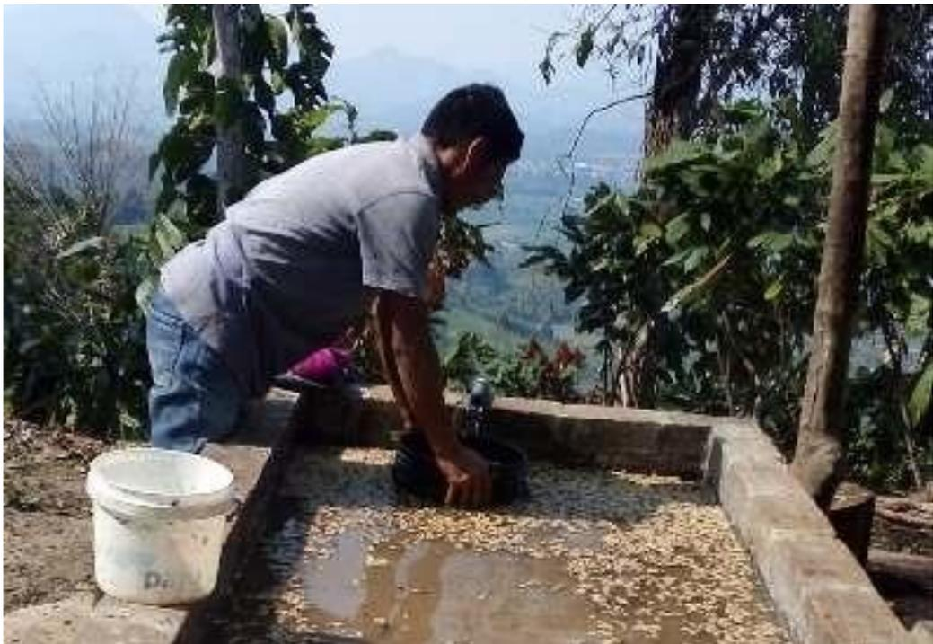
*Figura 23: cálculo del aforo de caudal sobre un tanque artesanal lavadero de café*
