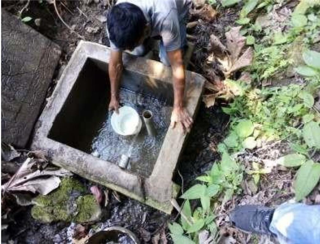
*Figura 22: Calculo del aforo del caudal*
