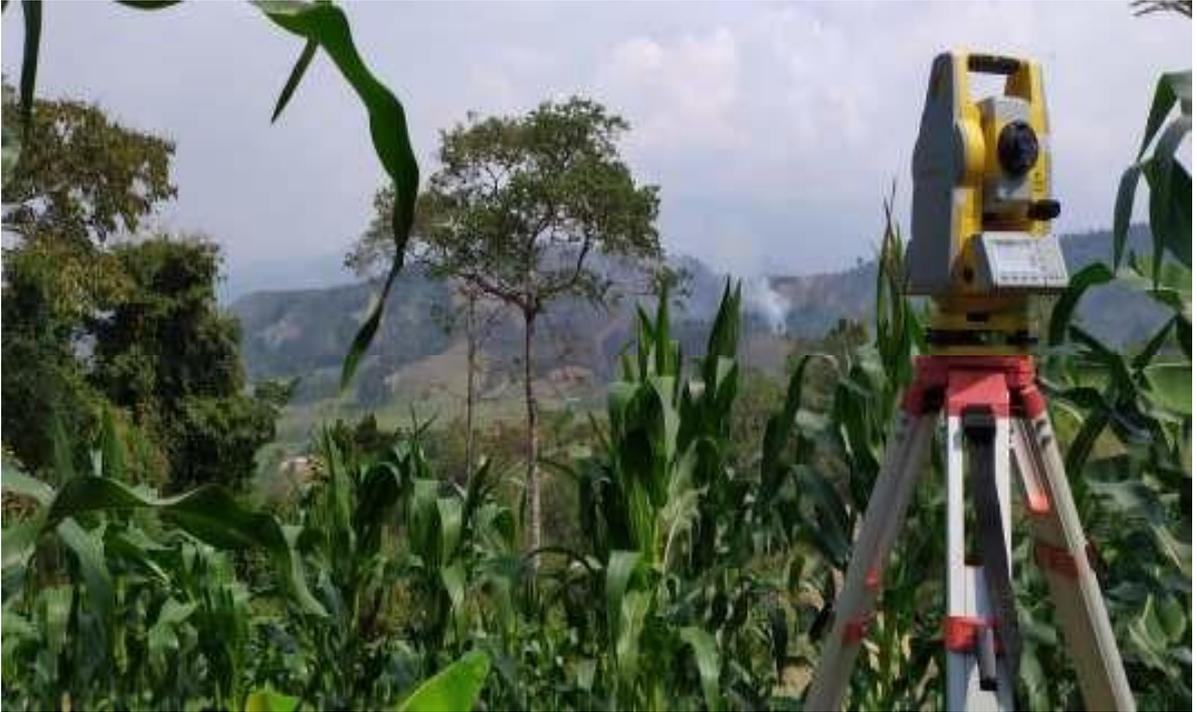
*Figura 30: Levantamiento topográfico en el reservorio*
