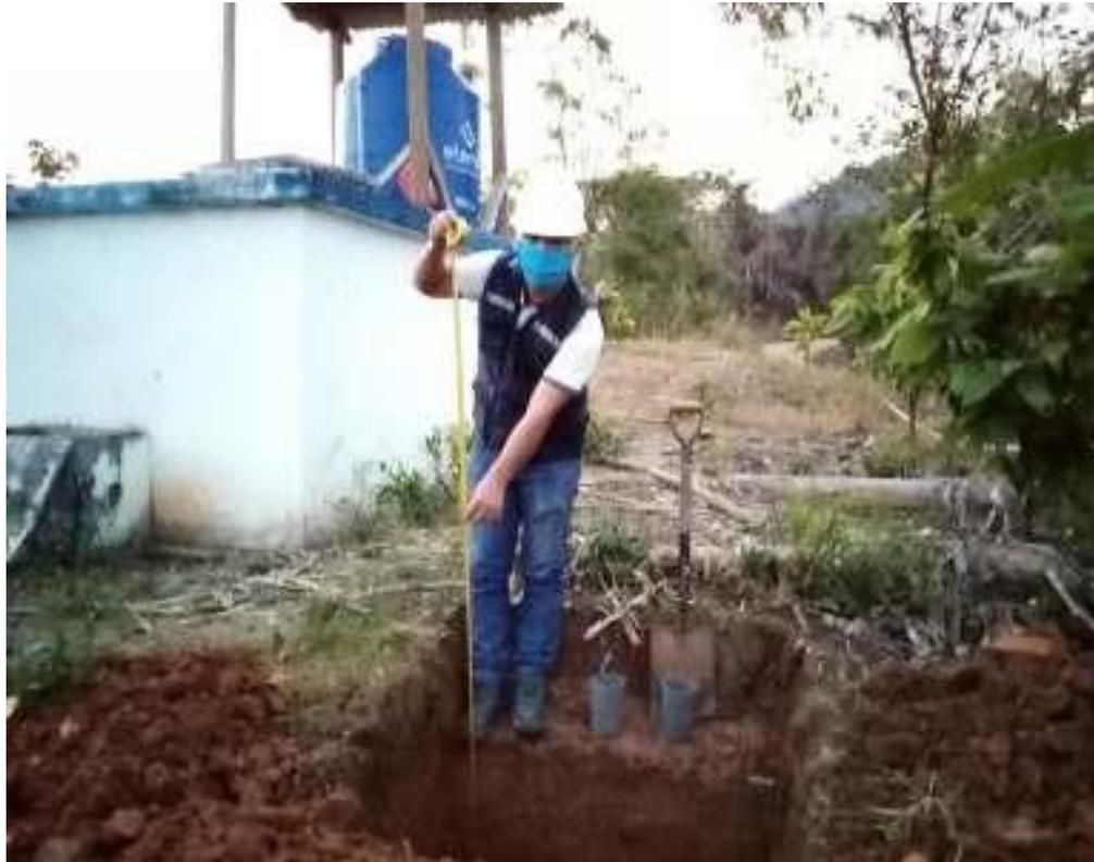
*Figura 36: Se verifica la excavación de calicata para la toma de muestra de suelo*
