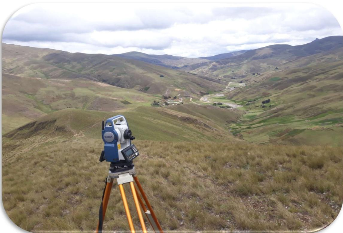
Fotografía 6: Equipo utilizado para el Levantamiento topografico (Estación Total)
