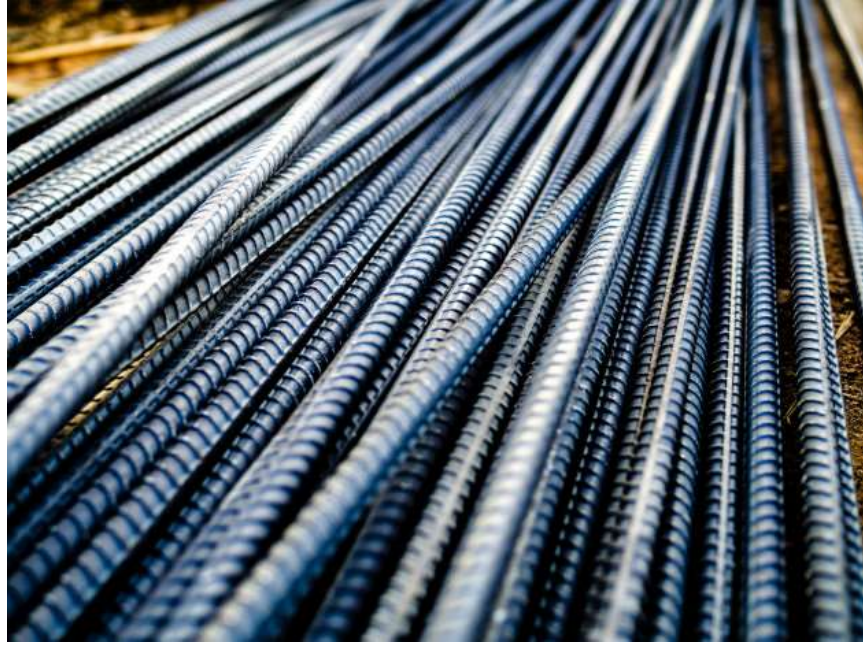
Figura 11: Acero de Refuerzo.
