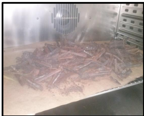
Imagen N° 2: secado de la muestra en la estufa a 65 °C
