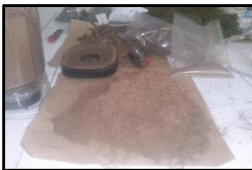
Imagen N° 4: pulverización de la muestra seca
