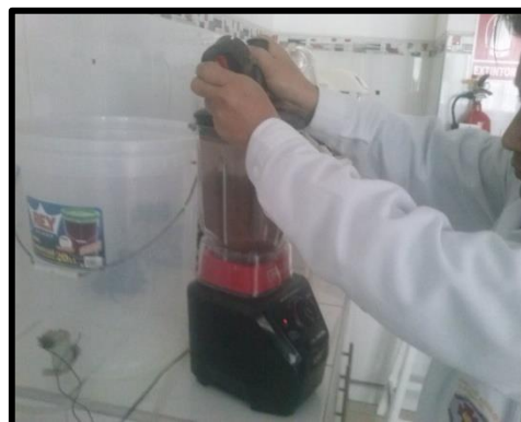
Imagen N° 3: pulverización de la muestra seca
