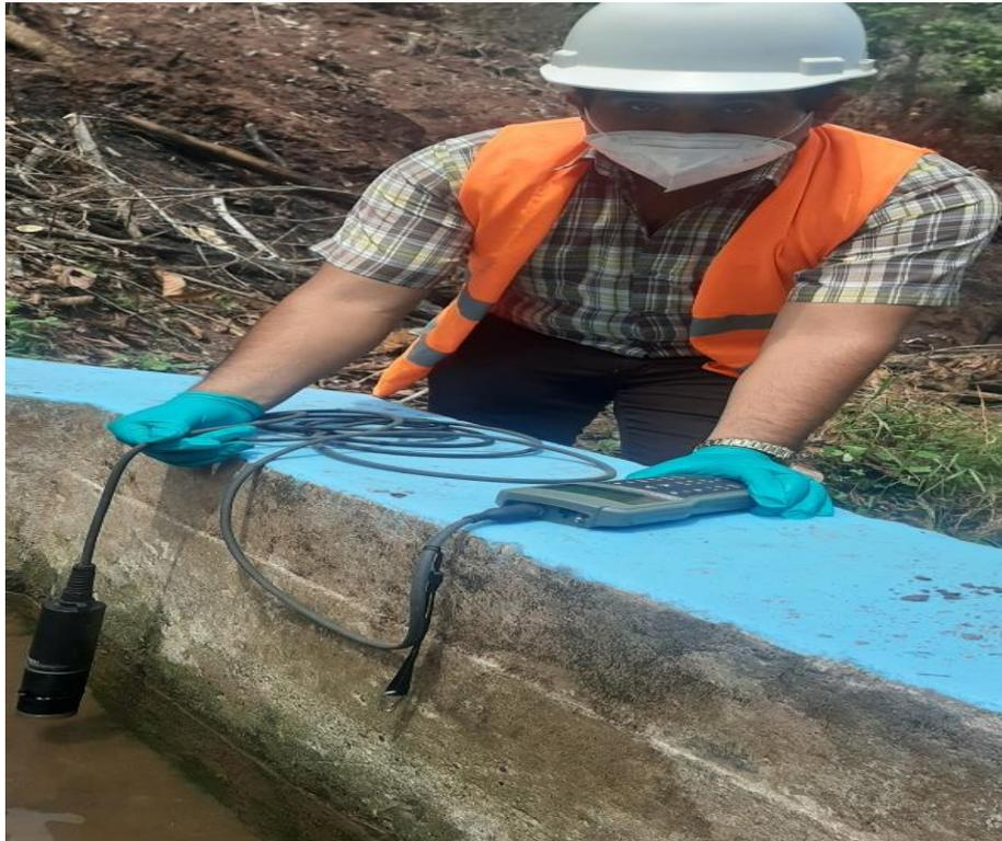
**Foto 6.** Aplicación del medidor de calidad de agua - multiparameter HANNA en in situ.
