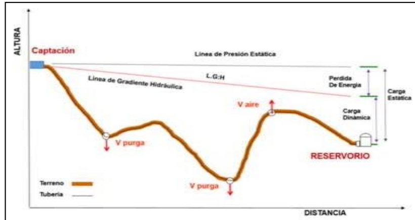
Figura 7: Línea gradiente hidráulica de línea de conducción Fuente: RM-192-2018 Vivienda.(17)
