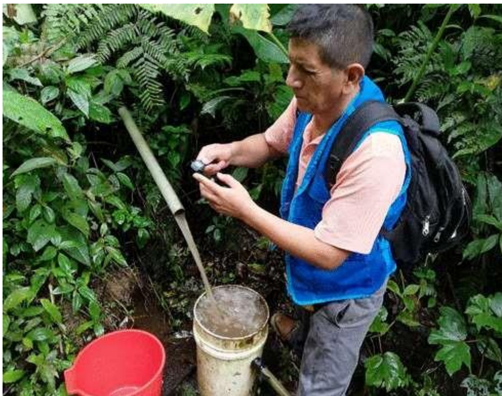
Foto 9: Realizando la lectura del cronometro para el aforo
