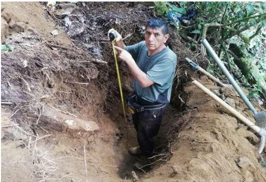
Foto 18: Haciendo la medición de la profundidad de la calicata
