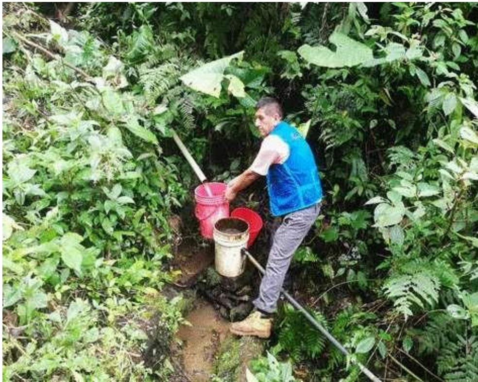
Foto 8: Realizando el aforo de la captación
