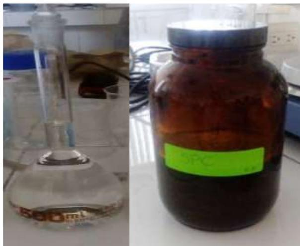
**Imagen 6:** Agregar 400mL de alcohol de 80° al pulverizado de 100 g.
