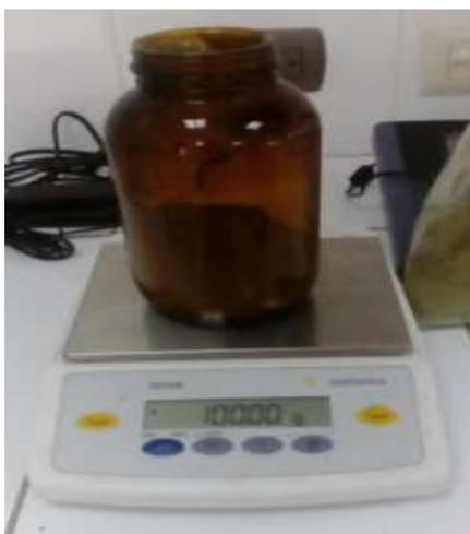
**Imagen 5:** Pesar lo pulverizado en la balanza hasta 100g para la maceración.
