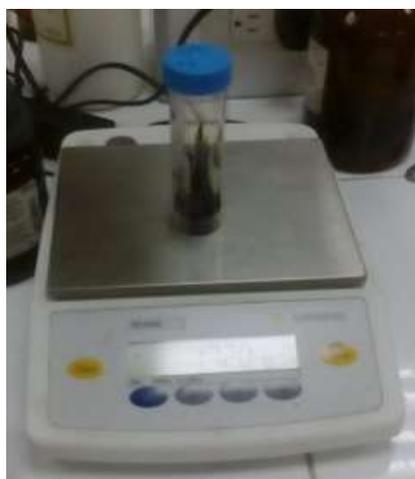
**Imagen 9:** La muestra semi solida obtenida del rotavapor se le coloco en un tubo falcón, luego se pesó la muestra y se aforro con papel aluminio para guardar a refrigeración hasta el uso.
