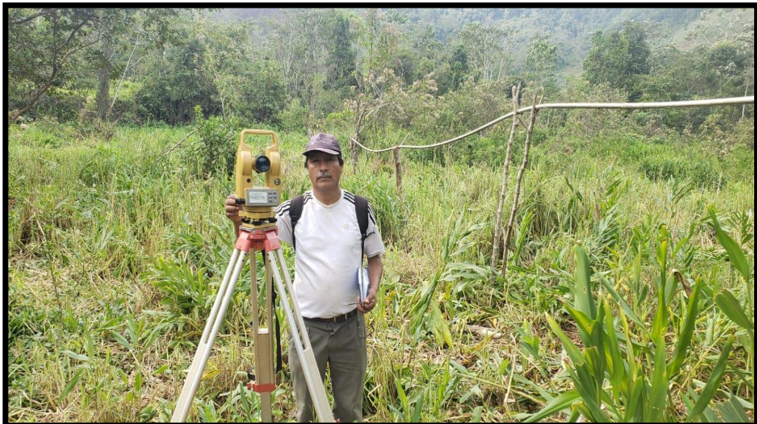
Figura 33: Levantamiento topografico de la linea de aducción.
