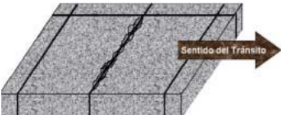
Figura 2.18: Esquema de falla denominada "Despostillamiento".
