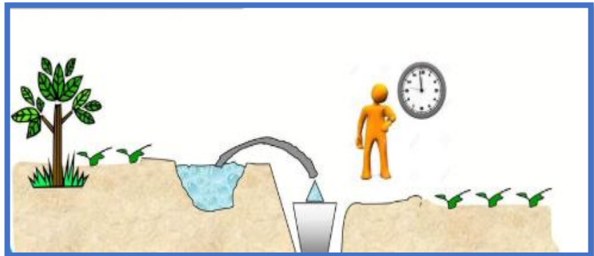
Figura 5. Medición del caudal por el método volumétrico
