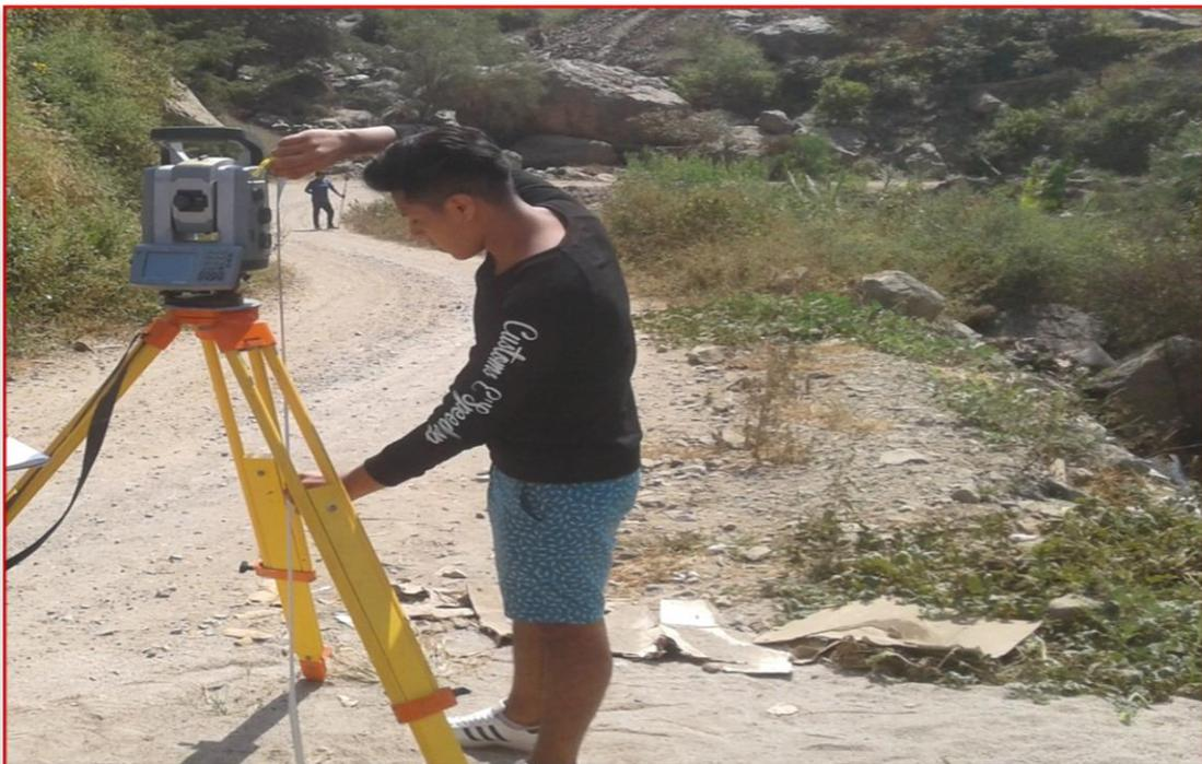
**Fotografía 08:** Tomando la altura de la estación total para realizar el levantamiento topográfico
