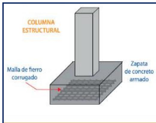
**Figura 31:** Columna de concreto armado.
