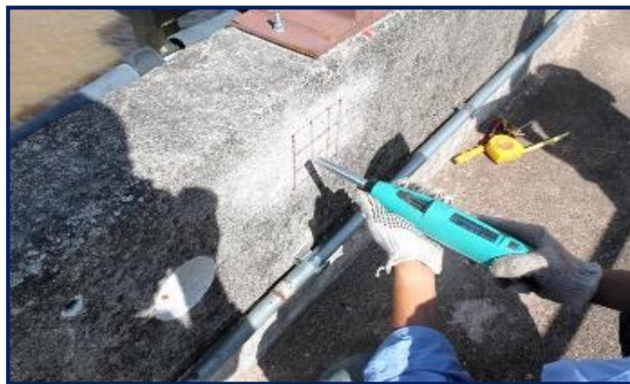
**Figura 43:** Evaluación del concreto por el Esclerómetro.
