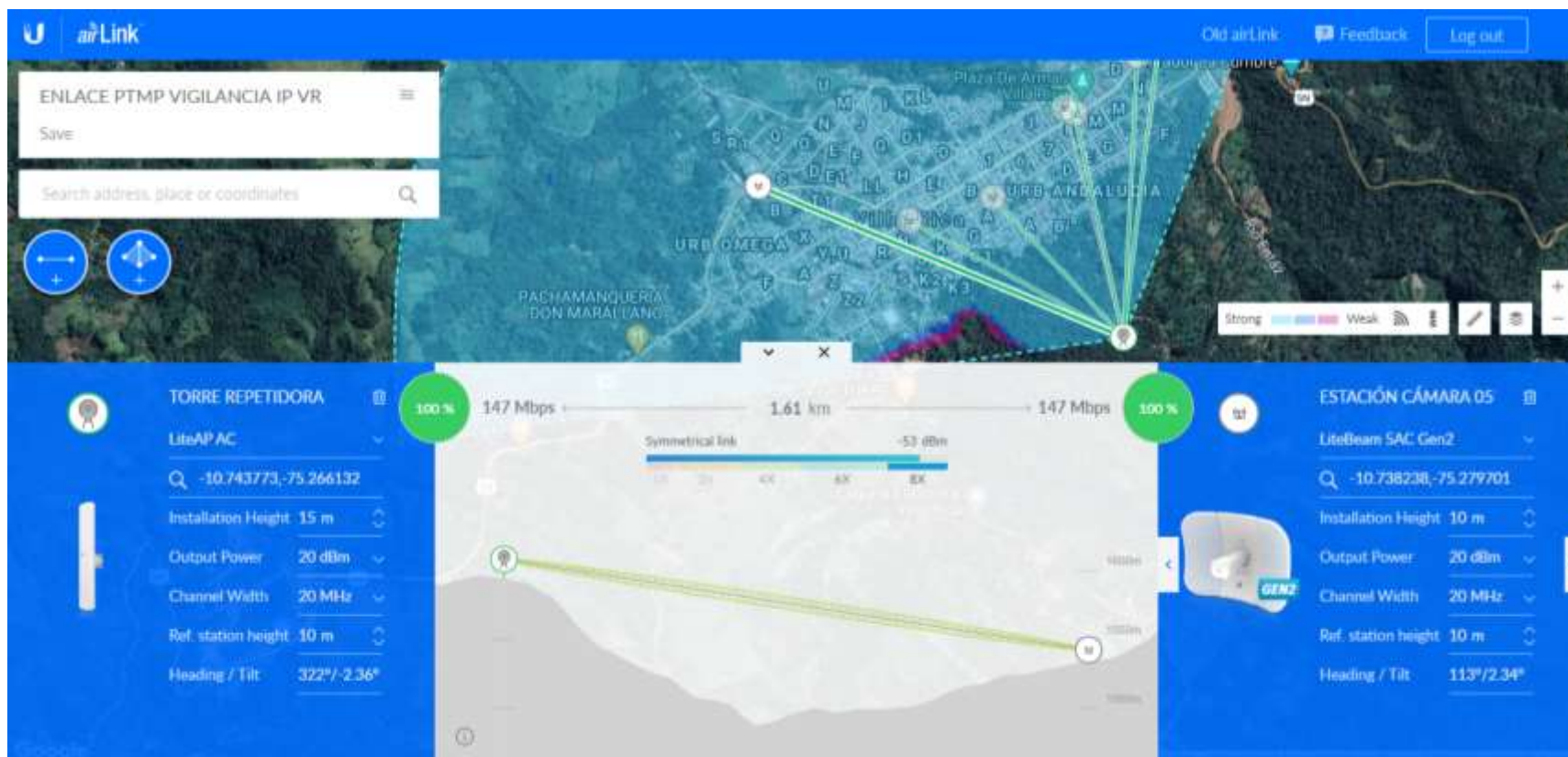
Gráfico Nro. 35: Radioenlace PTMP-Torre repetidora y estación de cámara 05
