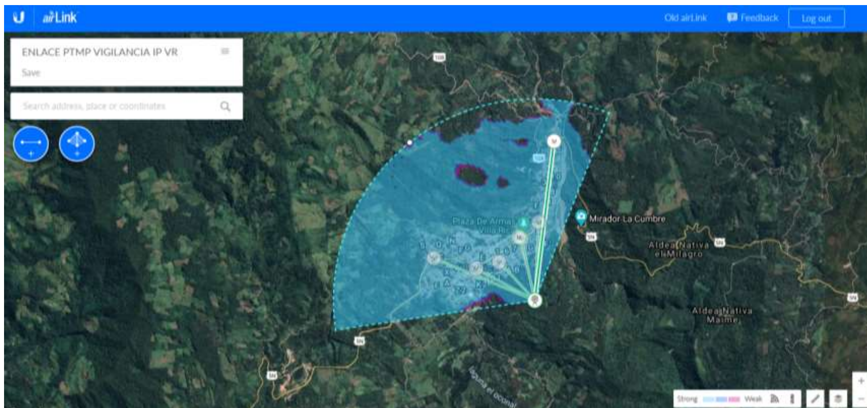
Gráfico Nro. 30: Radioenlace PTMP-Torre repetidora y estaciones de cámaras
