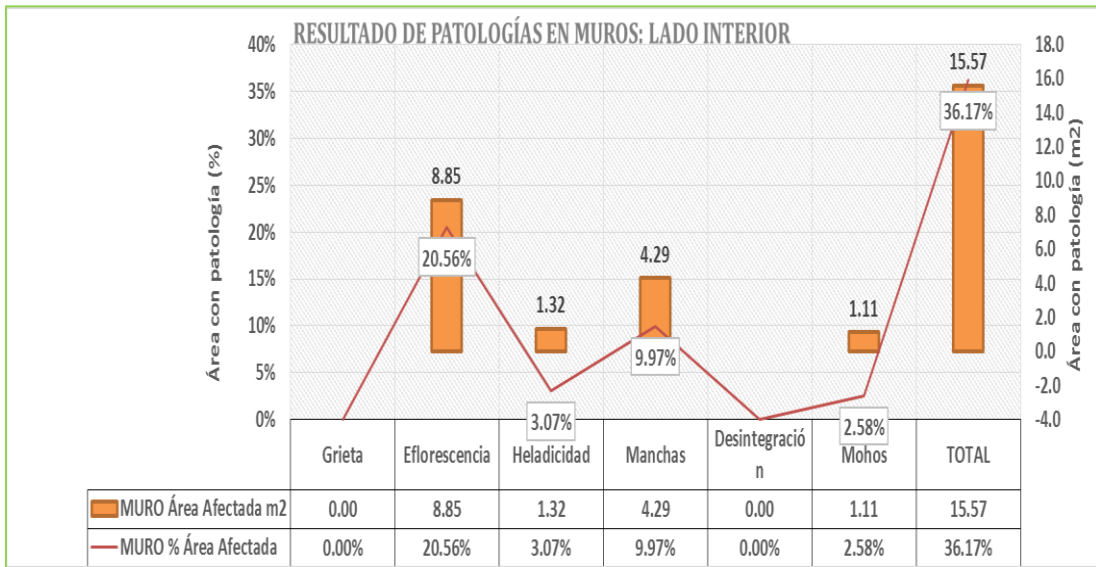
Gráfico 19: Muestra 05, Patologías en Muros – Lado Interior
