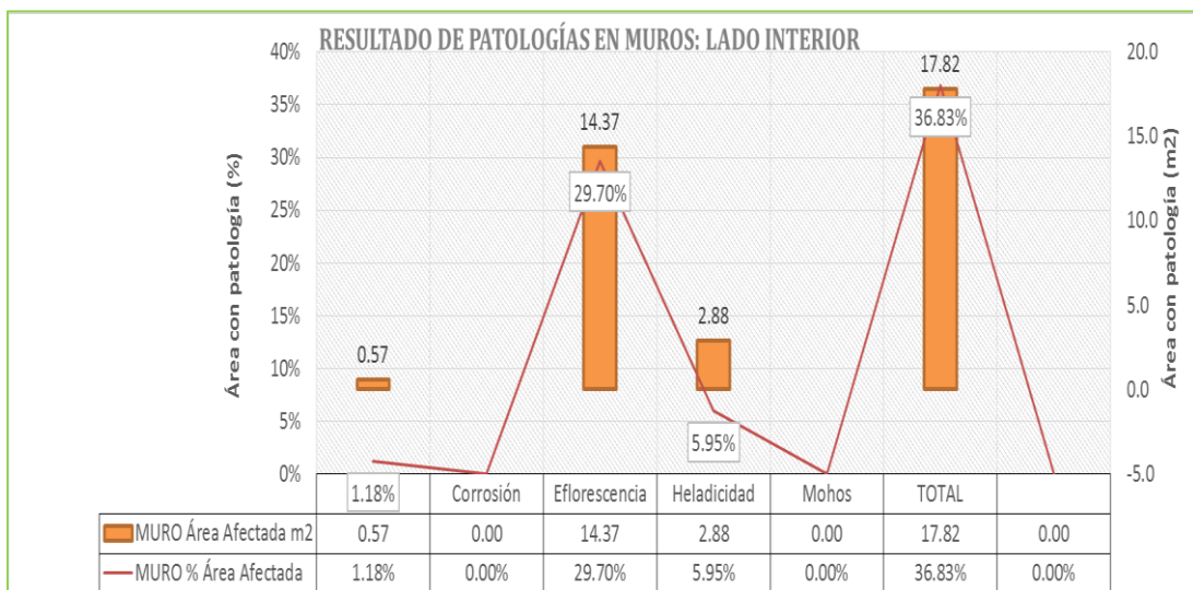
Gráfico 15: Muestra 04, Patologías en Muros – Lado Interior
