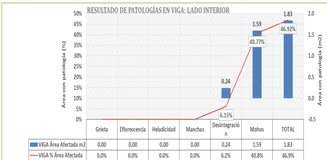
Gráfico 18: Muestra 05, Patologías en Vigas – Lado Interior
