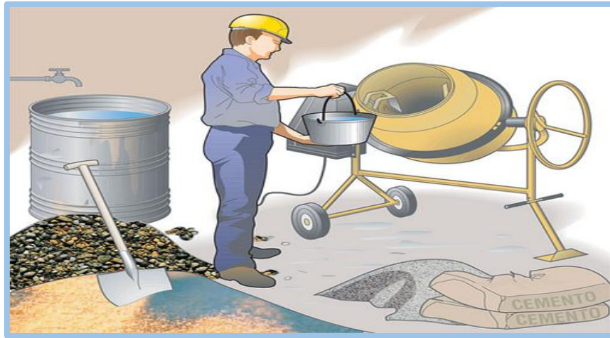
Imagen 06: Mescla de concreto.
