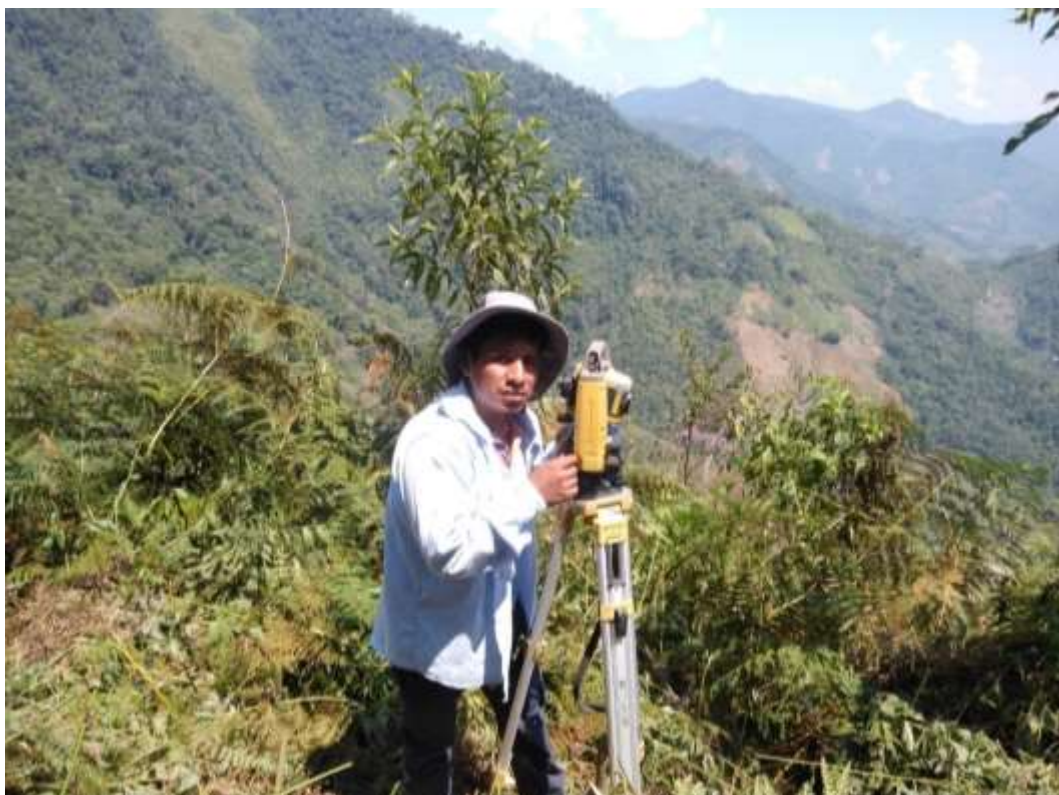
FOTO N° 1: levantamiento topográfico en la línea de conducción
